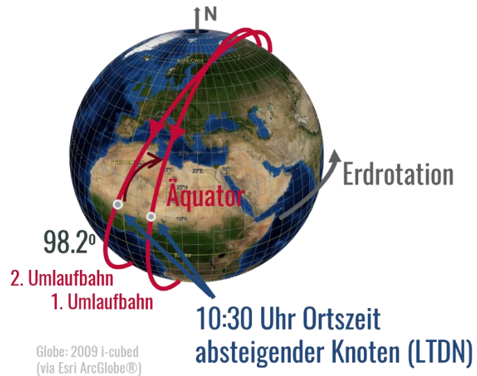
Abbildung 20 Nahpolare, sonnensynchrone Umlaufbahn. Brosinsky et al. (2022). Globe: 2009 i-cubed (via Esri ArcGlobe®)
