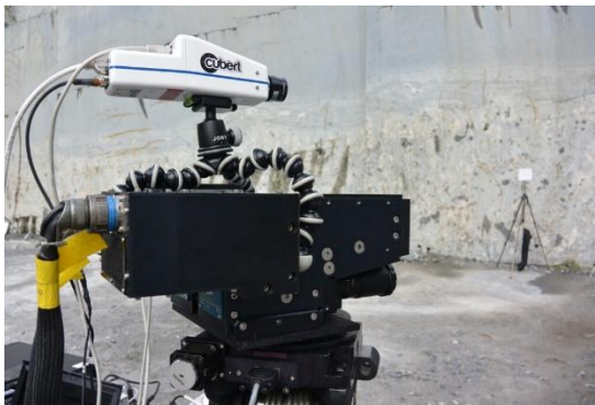
Abbildung 25 HySpex-Sensoren und eine Cubert-Kamera, die auf einer rotation stage (Rotationstisch) montiert sind, um eine Kulturstätte im Nahbereich zu scannen (Marienkirche, Frankfurt/Oder, Deutschland). HySpex Sensor nachgedruckt aus Rogaß et al. (2017) mit Genehmigung von MDPI, Foto der Cubert Kamera mit freundlicher Erlaubnis von Christian Mielke
