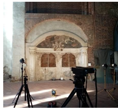
Abbildung 25 HySpex-Sensoren und eine Cubert-Kamera, die auf einer rotation stage (Rotationstisch) montiert sind, um eine Kulturstätte im Nahbereich zu scannen (Marienkirche, Frankfurt/Oder, Deutschland). HySpex Sensor nachgedruckt aus Rogaß et al. (2017) mit Genehmigung von MDPI, Foto der Cubert Kamera mit freundlicher Erlaubnis von Christian Mielke
